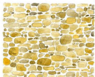
appareillage de moellons équarris et non équarris, de toute taille et non assisés.
