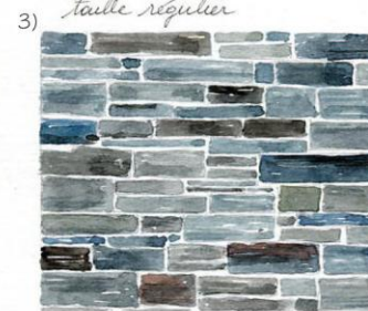
appareillage en pierre de schiste assisée.
