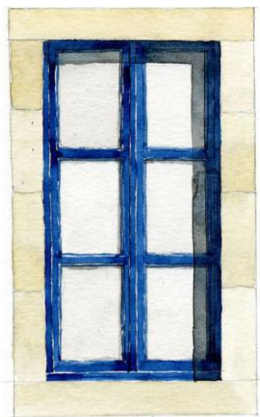
Fenêtre à 2 vantaux, 6 carreaux, en bois peint.
