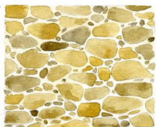
appareillage de gros et petits moellons, non équarris et non assisés.
